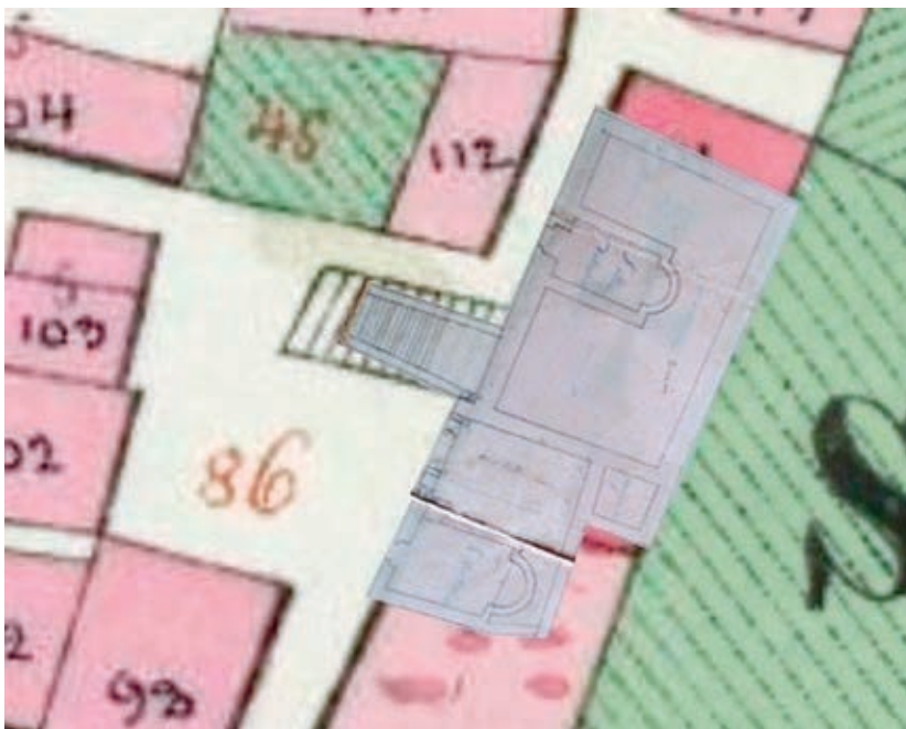
Slika 5. Arhivski crtež, osnova prizemlja preklapljena sa dijelom katastarsog plana iz 1838. g. na kome su predstavljene analizirane građevine: Crkva Sv. Josipa sa Crkvom Sv. Magdalene (ispod nivoa poda crkve), zvonik, Crkva Sv. Antona opata (u zoni prizemlja bivšeg samostana klarisa)
