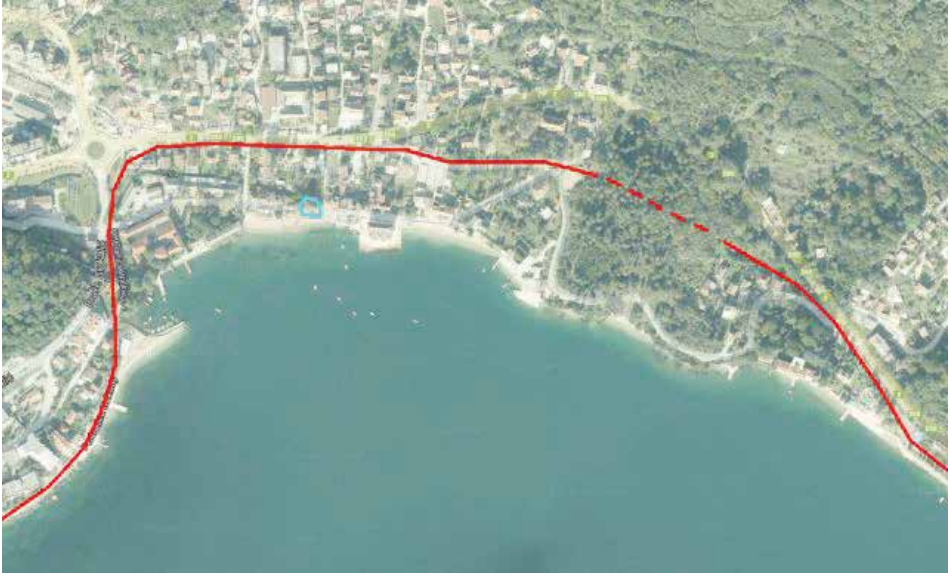
Слика 1. Траса жељезничке пруге кроз Херцег Нови, Мељине и Зеленику; на слици се види тунел пробијен кроз брдо Лаловина (испрекидана линија)
