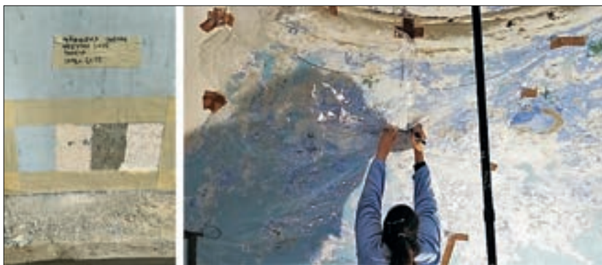
Sl. 20 a,b | Sondažna ispitivanja bojenog sloja u kupoli
